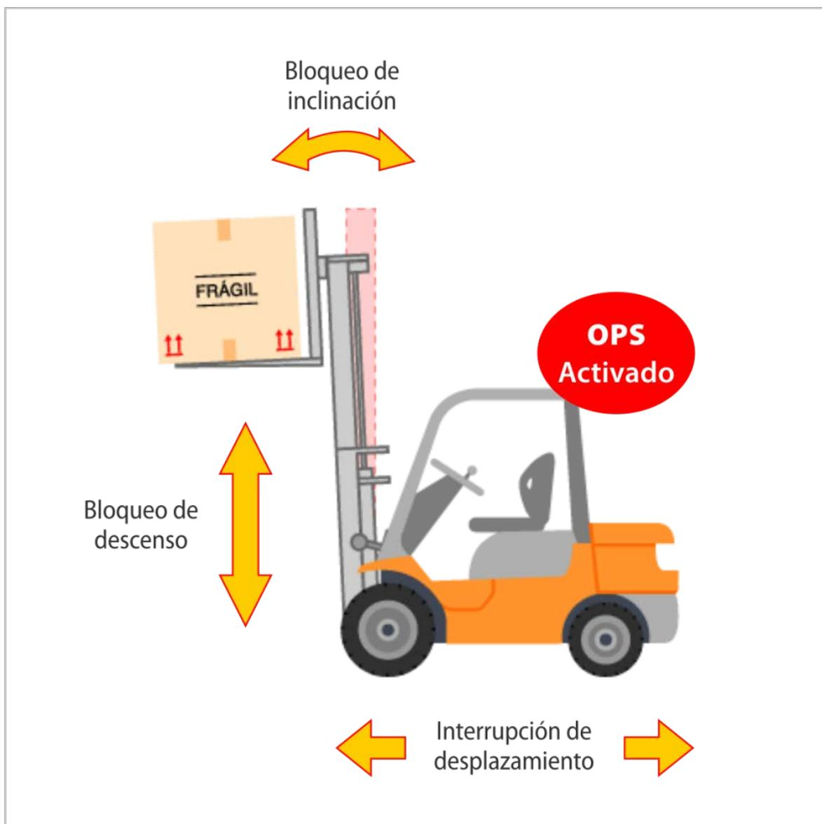
Nota: el OPS no opera sobre los frenos. Siempre active el freno de estacionamiento antes de salir del montacargas.
