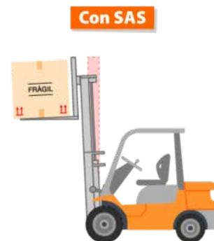
Este sistema detecta el peso y altura de la carga y automáticamente controla el ángulo de inclinación del mástil. Este sistema hace más difícil la caída de la carga, contribuyendo a mejorar la eficiencia del trabajo.
