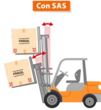
Este sistema previene el descenso cuando el motor no está en funcionamiento. Sistema de válvulas de control con reducidas pérdidas. Algo de líquido hidráulico fugará a través de las válvulas y retornará al tanque de aceite hidráulico. Este sistema reduce la cantidad de fuga y de ese modo la inclinación y el descenso natural del mástil.
