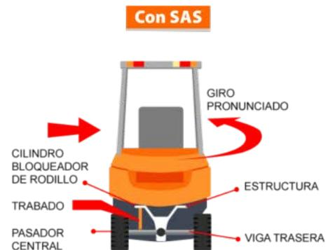
El SAS incorpora un cilindro bloqueador de rodillo. Este cambia el triángulo de estabilidad a un rectángulo inhibiendo a la viga trasera de su capacidad basculante. Ello proveerá mayor estabilidad durante maniobras de giro mejorando la productividad.
