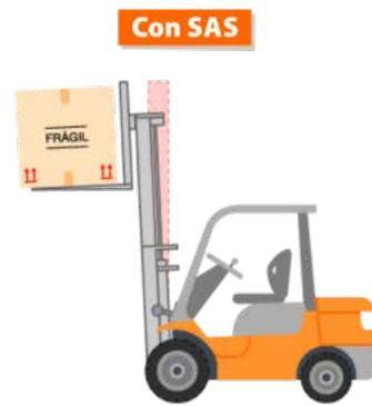
Controlador de funcionamiento de columna activa, reduce el ángulo, la velocidad de inclinación y las orquillas se regulan según el peso de la carga y la altura a la que se maneja.
