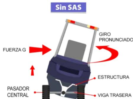
Debido al diseño del pasador central, un autoelevador posee solamente tres puntos de apoyo, aún cuando tuviere cuatro ruedas. Esto explica porque el autoelevador se inclinará hacia un lado durante una maniobra de giro pronunciado.
