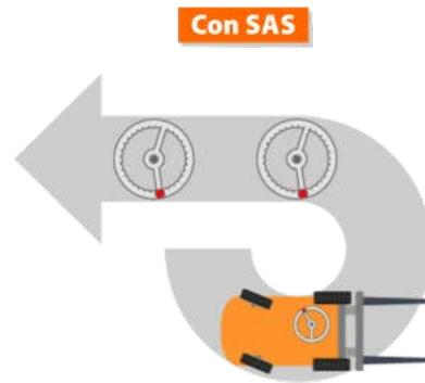
Hasta ahora, el demerito de la dirección totalmente hidráulica era la imposibilidad de mantener en concordancia el volante de dirección con respecto a la posición de las ruedas directrices.
