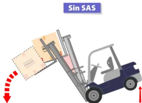
Si el operador inclina el mástil hacia adelante, cargado y a gran altura, ángulo de inclinación podría causar la caída de la carga o el equipo.
